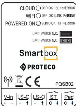
As entradas **LS-C** e **L-O** servem para detetar o estado (aberto/fechado) da automação; as saídas **ST** e **Ped** são acionadas pela aplicação, respetivamente para os comandos Start e Pedonal.
