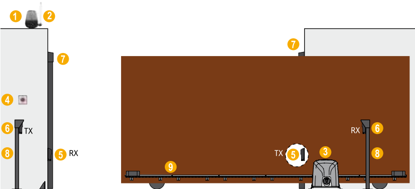
1_Clignotant 2_Antenne 3_Moteur avec carte de gestion et récepteur 4_Contacteur à clé 5_Photocellule fermeture 6_Photocellule ouverture 7_Barre palpeuse 8_Potelet pour photocellules 9_Crémaillère
