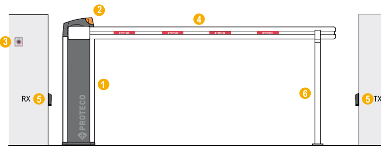
1_Barrière avec carte de gestion et récepteur radio 2_Clignotant 3_Contacteur à clé 4_Lisse aluminium 5_Phocellule fermeture 6_Support fixe
