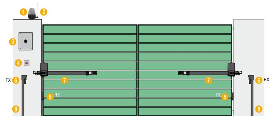
1\_Lámpara de señalización 2\_Antena exterior 3\_Cuadro de maniobra 4\_Selector de llave
