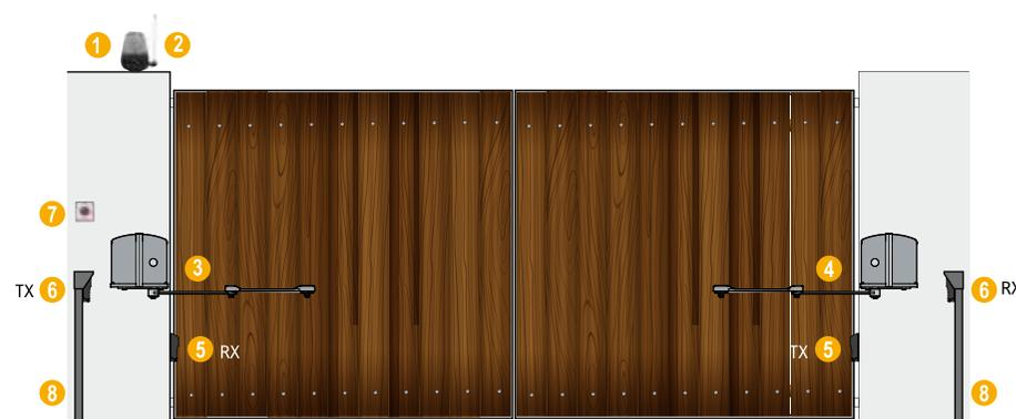
1\_Lámpara de señalización 2\_Antena exterior 3\_Cuadro de maniobra 4\_Selector de llave
