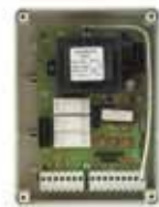
Q45 Control board 230V for rolling shutter Centrale di comando 230V per serranda
