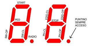
La cifra di sinistra mostra comandi e finecorsa (SW-OP ed SW-CL sono rispettivamente il finecorsa di apertura e di chiusura).
