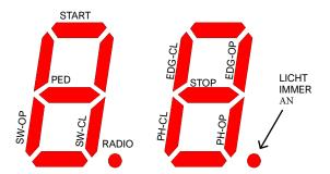
Die linke Ziffer zeigt Befehle und Endschalter (SW-OP und SW-CL sind die offenen bzw. geschlossenen Endschalter.
