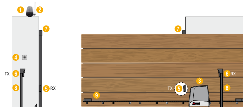
1_Lampeggiatore 2_Antenna da esterno 3_Motoriduttore con centrale e ricevitore radio 4_Selettore a chiave 5_Fotocellule CHIUSURA 6_Fotocellule APERTURA 7_Bordo sensibile 8_Colonnina fotocellule 9_Cremagliera
