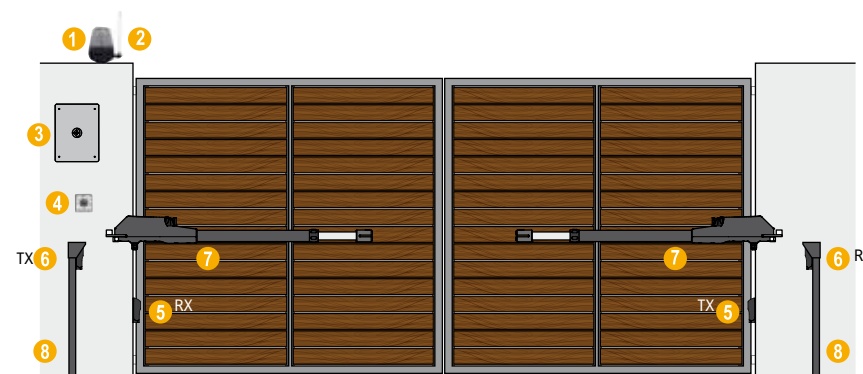
1_Lampeggiatore 2_Antenna da esterno 3_Centrale di comando 4_Selettore a chiave 5_Fotocellule CHIUSURA 6_Fotocellule APERTURA 7_Actuatori 8_Colonnina fotocellule
