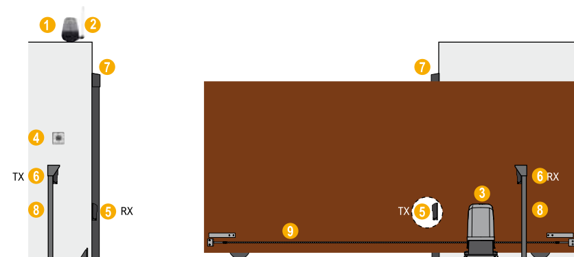
1_ Lámpara de señalización 2_ Antena exterior 3_ Accionador integrado con cuadro de maniobra y receptor 4_ Selector de llave 5_ Fotocélula exterior 6_ Fotocélula interior 7_ Banda de seguridad 8_ Apoyo fijo para fotocélulas 9_ Cadena
