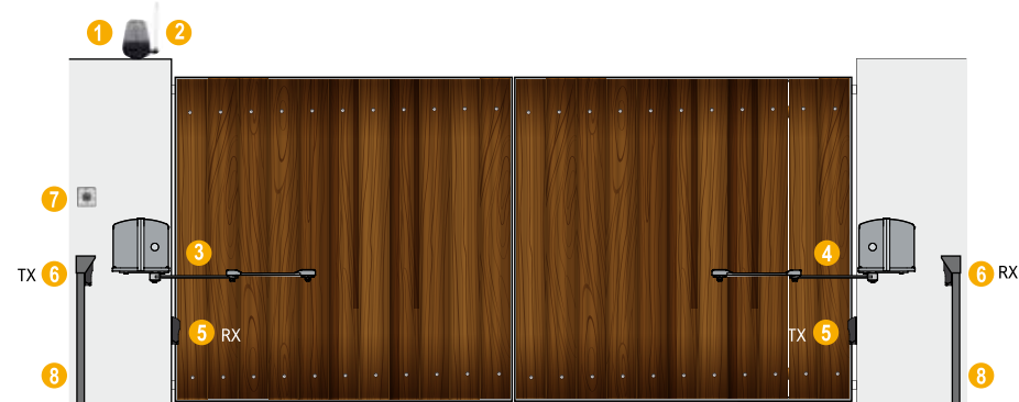
1_Lámpara de señalización 2_Antena exterior 3_Cuadro de maniobra 4_Selector de llave 5_Fotocélula exterior 6_Fotocélula interior 7_Motores 8_Apoyo fijo para fotocélulas
